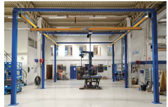
En bärstålkonstruktion kan lösa sämre bärighet.
