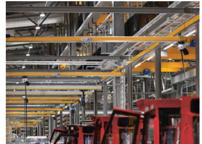
En monteringslinje är anpassad för produktens vikt och storlek. Här fungerar ABUS lätttraverssystem bra.
